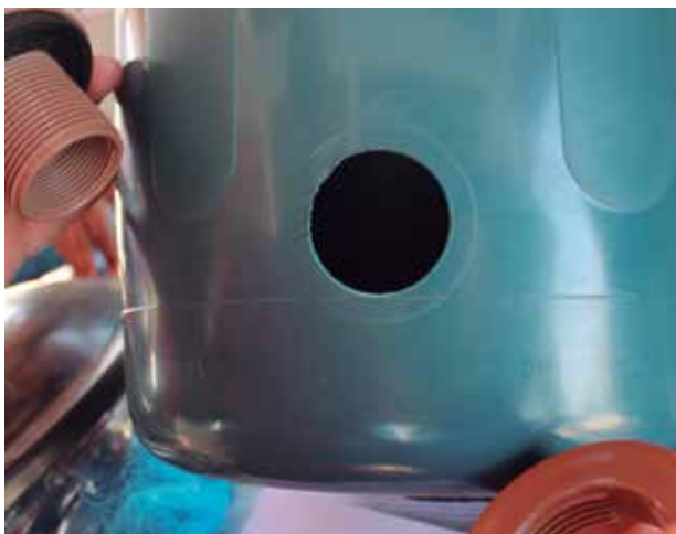
Balde sedimentador com furo para receber adaptador.
