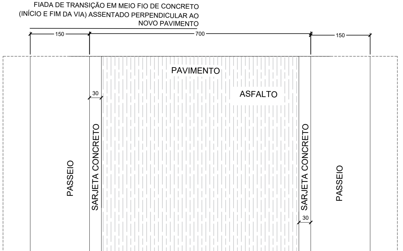
DETALHE 01 - VIA/ SARJETA / PASSEIO ESC 1 --- 50
