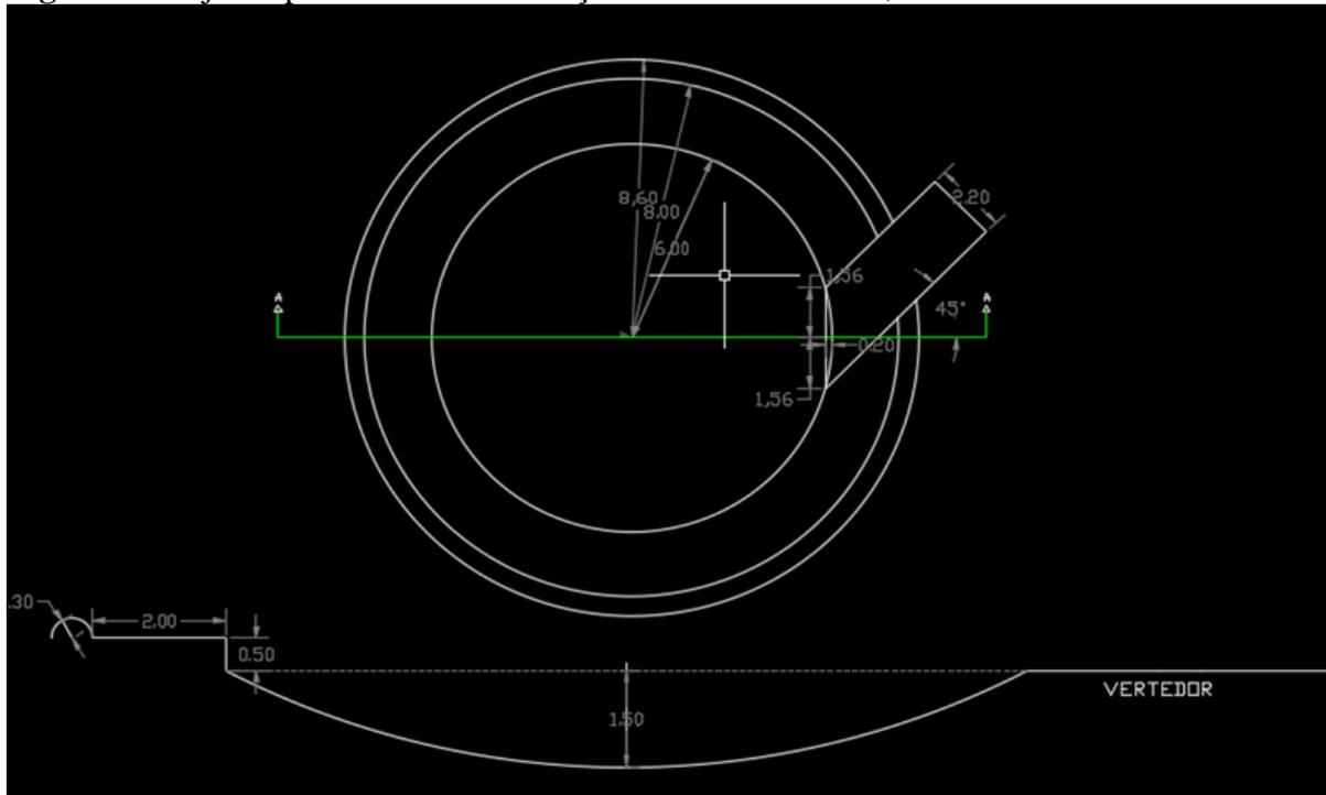
**Figura 3.** Projeto típico bacia de contenção de enxurrada de 12,0 metros de raio.
