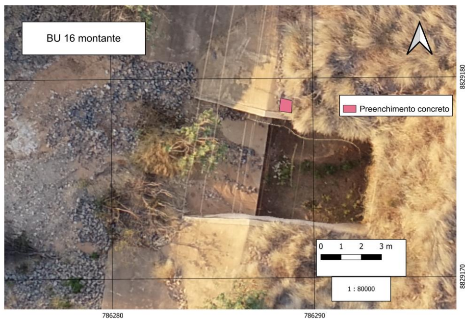
Figura 6 - Foto ilustrativa da construção da mureta de proteção e da obstrução da entrada do bueiro.
