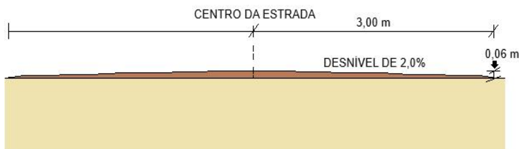
Figura 02: desenho ilustrativo para o caimento da estrada após a regularização do subleito, onde o centro da estrada é o ponto de maior cota, com desnível de 2,0%.
