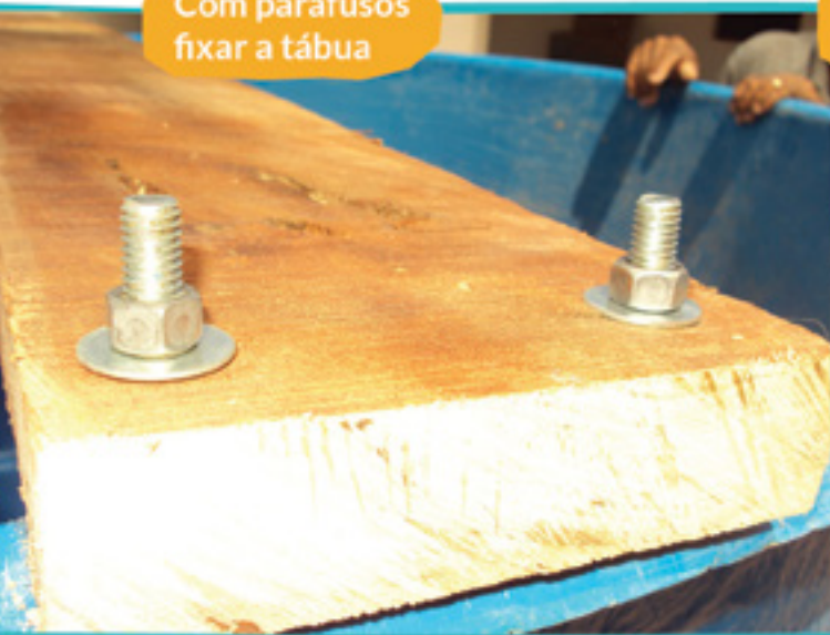
Fixação da tábua na caixa de fibra
