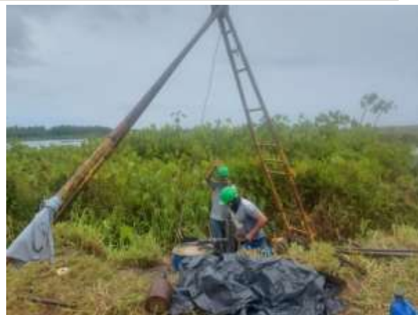
Foto 08 EXECUÇÃO DE SONDAGEM À PERCUSSÃO (SPT).
