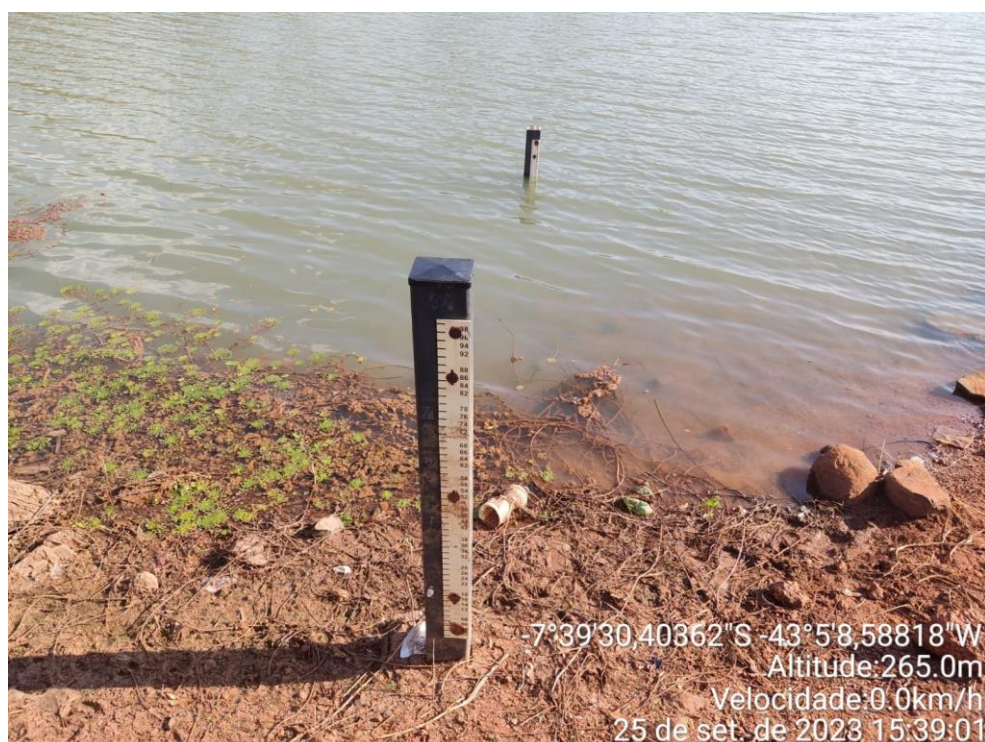
Figura 2 – Marcação de Nível da Água no Lago da Barragem dos Poços
