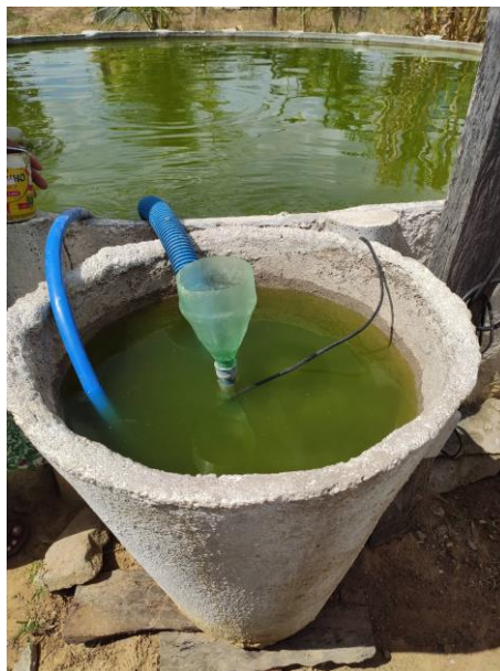
Figura 11: Demonstração do sedimentador. Fonte: CODEVASF.
