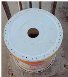
Figura 10: Biofiltro com destaque para furos no fundo do balde. Fonte: Guilherme et al , 2019.
