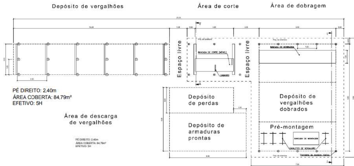
Figura 8 – Central de Armaduras (Obras de Pequeno Porte)
