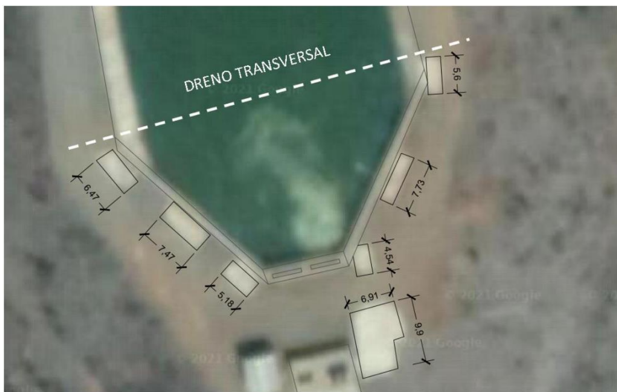
Blocos de concreto criados para preenchimento de antigas trincheiras de inspeção
