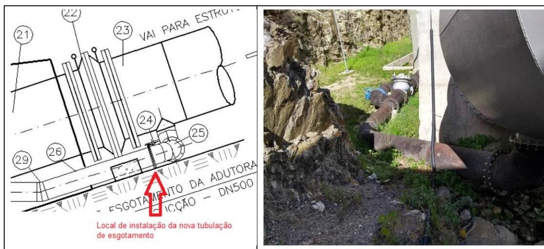
Foto 23 - Ajuste necessário no sistema de esgotamento da adutora
