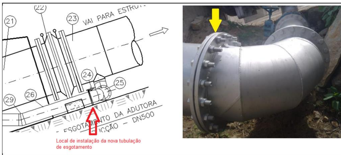
Foto 11 – Ajuste necessário no sistema de esgotamento da adutora
