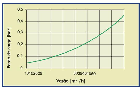
Diagrama obtido em prova de laboratório realizado à temperatura ambiente, com água pura e descarga livre, e filtro de 120 mesh.
