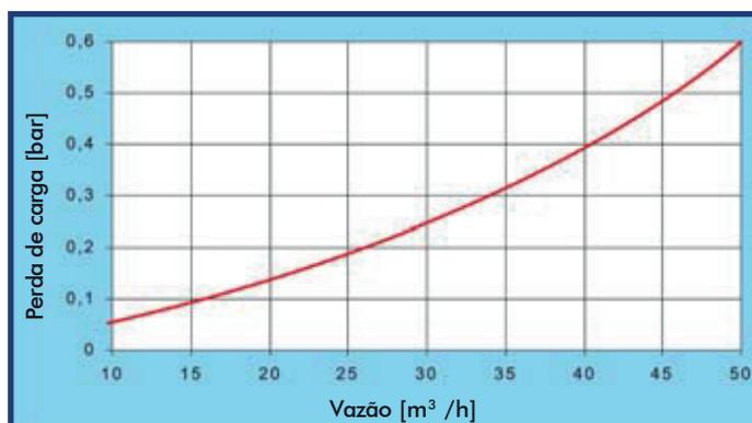
Diagrama obtido em prova de laboratório realizado à temperatura ambiente, com água pura e descarga livre, e filtro de 120 mesh.
