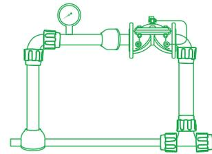
Alta qualidade e durabilidade, os cavaletes de polietileno também contam com conexões de compressão que garantem flexibilidade de uso no campo.
