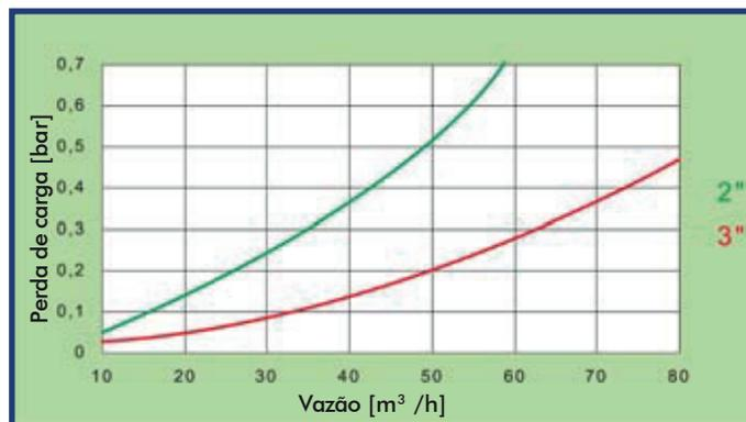
Diagrama obtido em prova de laboratório realizado à temperatura ambiente, com água pura e descarga livre, e filtro de 120 mesh.
