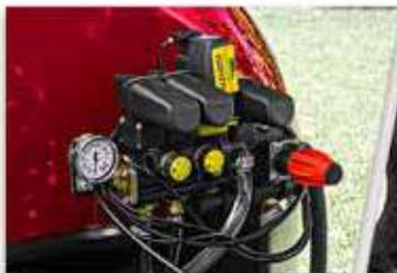
Comando elétrico de duas vias, vazão de 150 l/min e 40 BAR de pressão.
