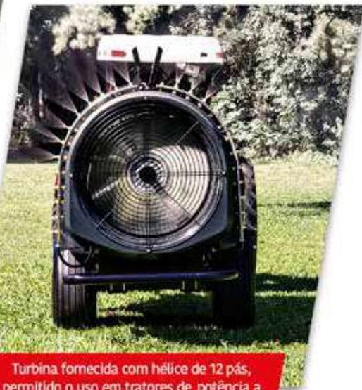
Turbina fornecida com hélice de 12 pás, permitindo o uso em tratores de potência a partir de 75 CV.
