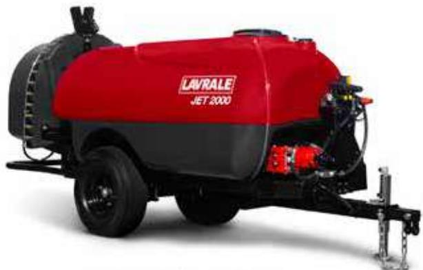
Regulagem de largura e altura dos rodados, proporcionando maior estabilidade do conjunto Trator/Pulverizador no trabalho em terrenos acidentados; Sistema possui 2 agitadores hidráulicos, um na dianteira e
