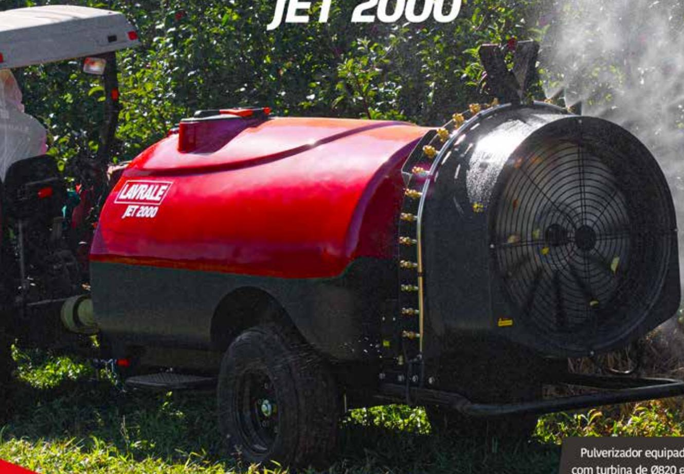
Pulverizador equipado com turbina de Ø820 e 26 porta bicos BIJET com antigotejo.
