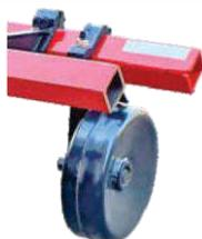
Permite manter a altura da barra-porta-ferramentas, aliviando o sistema hidráulico de três pontos do trator.
