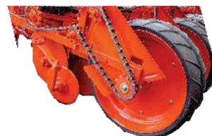
Roda traseira com banda de borracha com alívio central para a compactação da semente. Montada em quadro pivotado independente com sistema de regulagens de profundidade.
